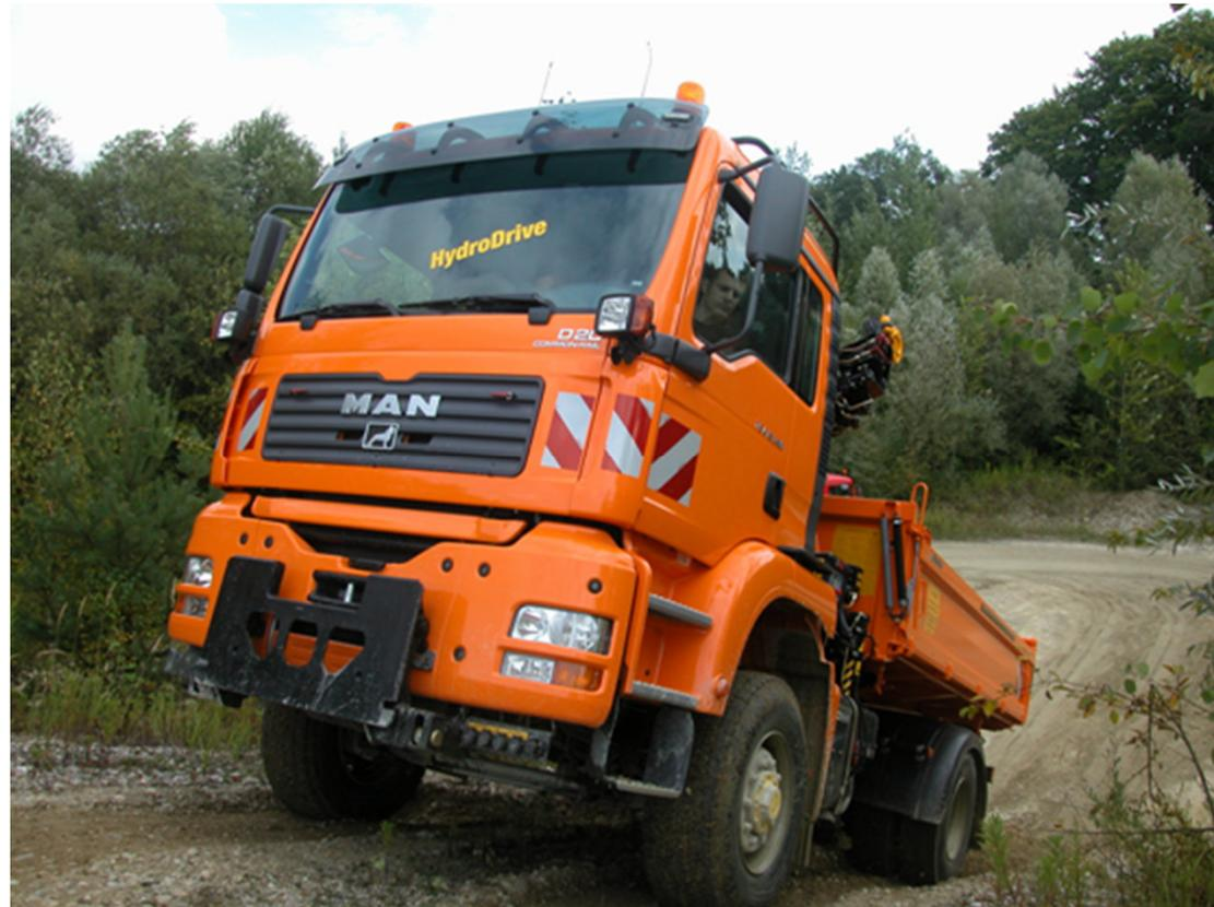
**Ricordare che l'HydroDrive si disinserisce a 28 km/h**
